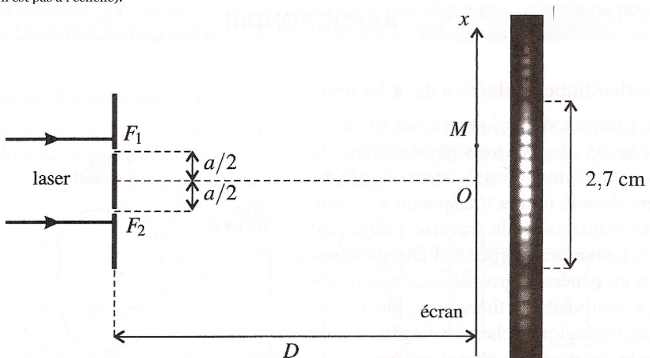
Sur l'écran, on observe une figure symétrique autour d'un point O, la lumière se répartissant le long d'un axe (Ox) perpendiculaire aux fentes. On observe une tache centrale très lumineuse de largeur 2,7 cm dont l'éclairement est modulé, ainsi que des taches latérales beaucoup moins lumineuses. Le but de l'exercice est d'expliquer ces observations.
