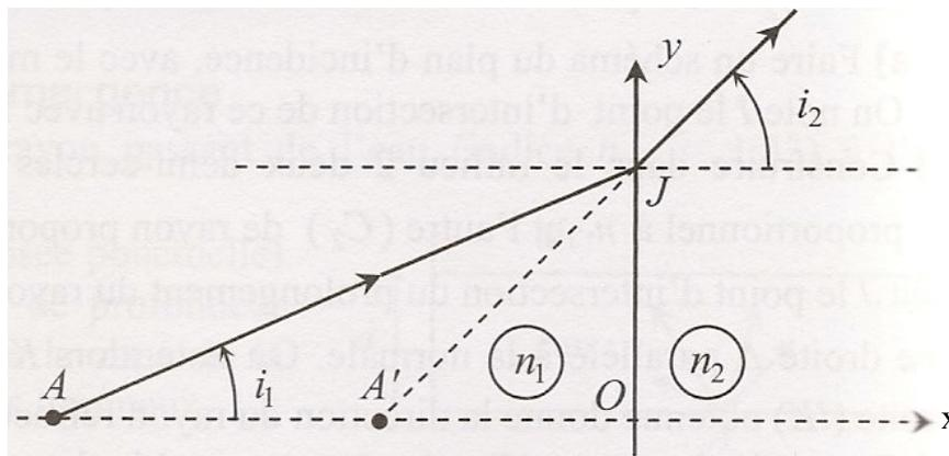
1) Exprimer  $\overline{OA'}$  en fonction de  $\overline{OA}$  et des angles  $i_1$  et  $i_2$  (rem : les distances avec des barres au dessus sont des distances algébriques, c'est à dire qu'elles peuvent être positives ou négatives selon si elles sont dans le sens de l'axe optique ou dans le sens opposé). Le système optique constitué du dioptre plan est-il stigmatique ?
