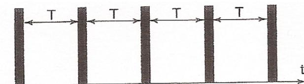
5) Quelle est la valeur minimale de  $T$  pour que les impulsions soient séparées à la sortie ?
