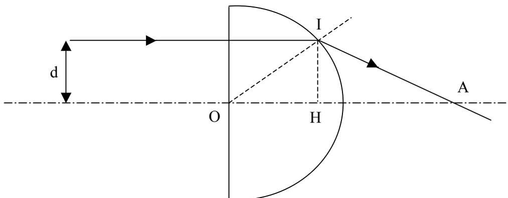
Le rayon arrive normalement sur la face plane de la demi-boule, il est écarté d'une distance  $d$  par rapport à l'axe optique. On note  $I$  le point d'incidence sur la partie sphérique,  $i$  l'angle d'incidence et  $r$  l'angle de réfraction en ce point. Le rayon émergent, lorsqu'il existe, coupe l'axe en  $A$ .
