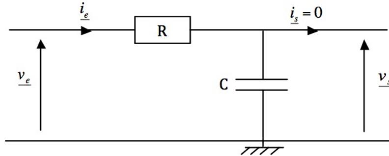
FIGURE 6 – Exemple de filtre passe-bas d'ordre 1. Les bornes de droite permettent de connecter un appareil en sortie du filtre (à "la charge"). On va faire l'étude dans le cas où la sortie est laissée ouverte (rien n'est connecté), donc  $i_s = 0$ .
