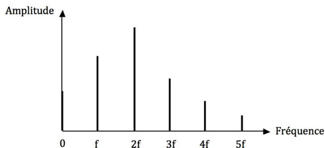
FIGURE 15 – Exemple de spectre d'un signal périodique
