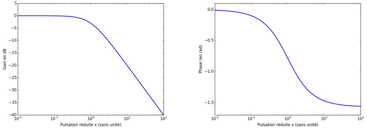
FIGURE 7 – Diagramme de Bode d'un filtre passe-bas d'ordre 1 (on a représenté 4 décades).
