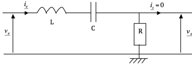
FIGURE 13 – Exemple de filtre passe bas d'ordre 2
