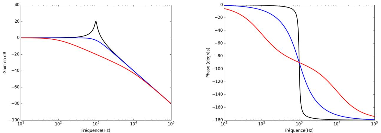
FIGURE 12 – Diagramme de Bode pour un filtre passe bas d'ordre 2 de fréquence propre  $f_0 = 1,0 kHz$ . On a pris  $Q = 10$  (courbe du dessus, en noir : notez la résonance),  $Q = \frac{1}{\sqrt{2}}$  (au milieu, en bleu) et  $Q = 0,1$  (en bas, en rouge)
