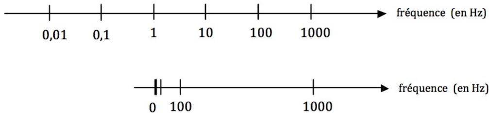
FIGURE 5 – Comparaison entre une échelle logarithmique (en haut) et une échelle linéaire normale (en bas). On voit que sur l'échelle log, les hautes fréquences et les basses fréquences sont aussi visibles les unes que les autres, tandis que sur une échelle normale les basses fréquences sont invisibles. La fréquence de 0 Hz n'apparaît pas sur l'échelle log (elle est rejetée à l'infini à gauche)
