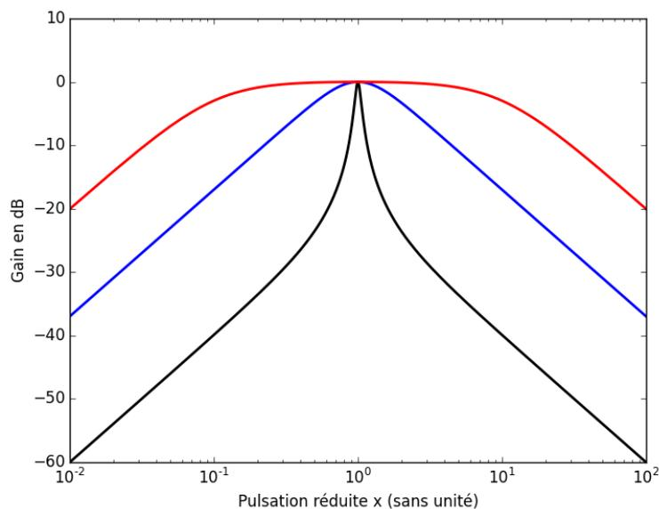
FIGURE 14 – Diagramme de Bode (gain seulement) d'un filtre passe-bande d'ordre 2 pour  $Q = 10$  (en bas, en noir),  $Q = \frac{1}{\sqrt{2}}$  (au milieu, en bleu) et  $Q = 0,1$  (en haut, en rouge). Notez que dans tous les cas on a des asymptotes de pente  $+20 dB/dec$  à basse fréquence et  $-20 dB/dec$  à haute fréquence mais que la bande passante est d'autant plus étroite que  $Q$  est élevé.
