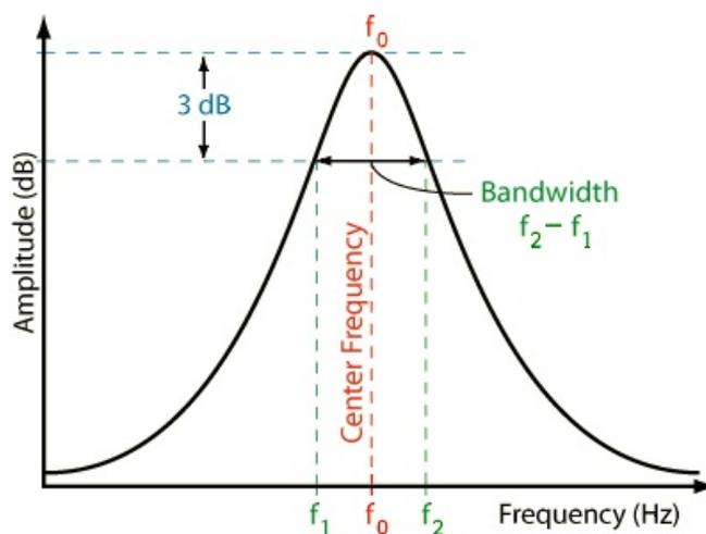
FIGURE 4 – Illustration de ce que représente la bande passante (contrairement à ce que peut laisser penser le dessin, la fréquence du maximum n'est pas forcément au milieu de la bande passante)
