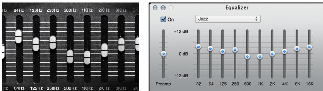
FIGURE 1 – Exemples d'égaliseurs ("equalizer" en anglais) : à gauche un égaliseur analogique, comme on peut en trouver dans un studio d'enregistrement ou sur une chaîne Hi-Fi, à droite, un égaliseur numérique d'un ordinateur
