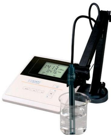
FIGURE 4 – Conductimètre classique de laboratoire
