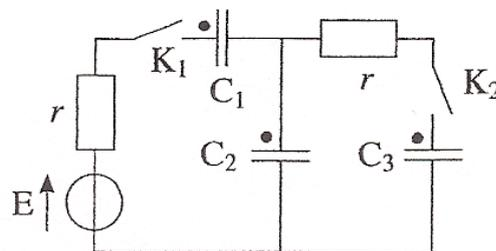
1. On ferme l'interrupteur  $K_1$  tandis que l'interrupteur  $K_2$  reste ouvert.
