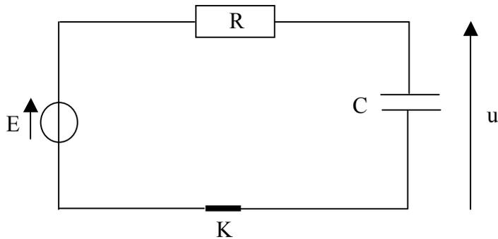
Le condensateur était initialement déchargé et on a fermé l'interrupteur K à  $t = 0$ .
