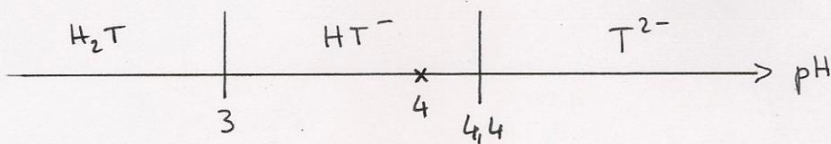
On voit qu'à  $\text{pH} = 4$ , l'espèce majoritaire est  $\text{HT}^-$ ,  $\text{T}^{2-}$  est en concentration non négligeable et  $\text{H}_2\text{T}$  est dix fois plus faible que  $\text{HT}^-$  (d'après la formule  $\text{pH} = \text{pK}_a + \log \frac{[\text{base}]}{[\text{acide}]}$ ).
