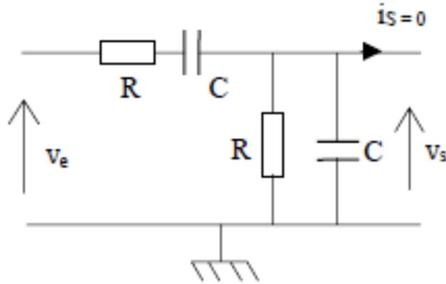
1) Déterminer, en régime sinusoïdal forcé, la fonction de transfert de ce filtre et la mettre sous la forme :
