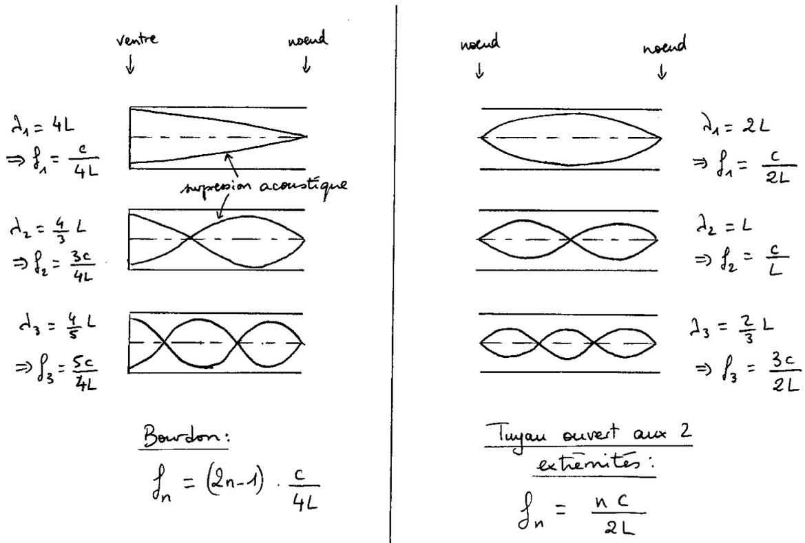
FIGURE 2 – Comparaison des trois premiers modes propres d'un tuyau ouvert aux deux extrémités (à droite) et d'un tuyau ouvert d'un côté et fermé de l'autre (à gauche).
